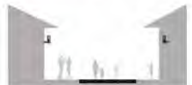
Peatonal Principal, Vehicular Restringido Calzada nivelada
